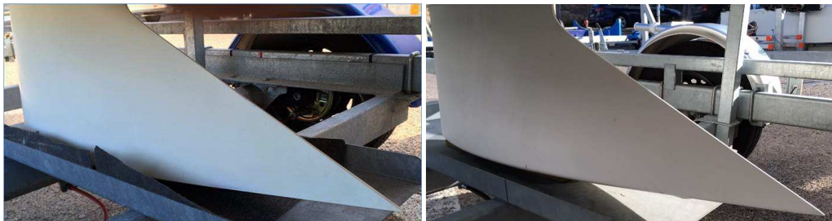
A gauche une quille modifiée avec un bas et des sorties optimisées par rapport à une quille standard à droite.
